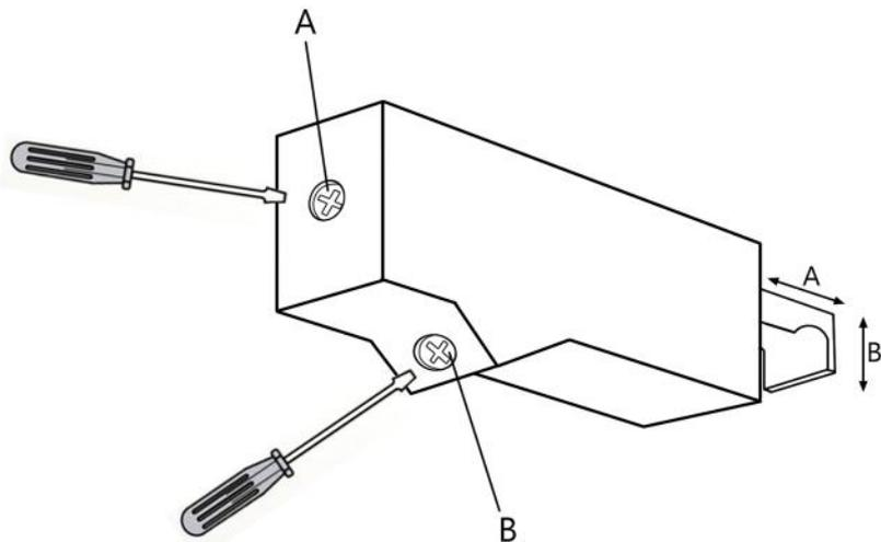
Zawieszki posiadają regulację w dwóch płaszczyznach. Śrubka "A" służy do regulacji w poziomie. Śrubka "B" służy do regulacji w pionie.
